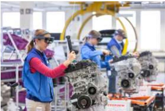
AR-Unterstützung bei der Motoren-Serienproduktion @BMW
